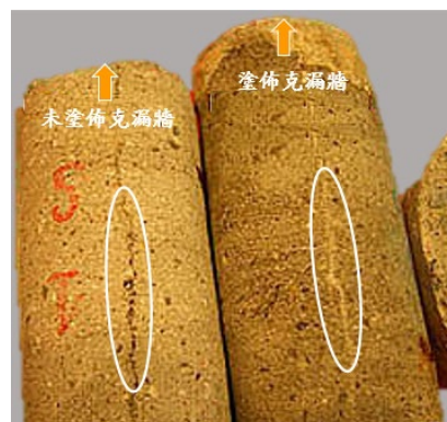
將試體泡水至頂端，未塗佈與已塗佈「克漏牆滲透結晶防水劑」所呈現裂縫修補的狀態。
