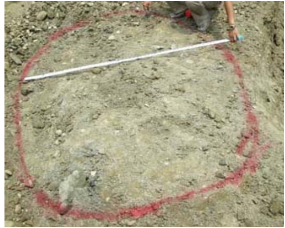
測量固結水泥漿的擴散範圍
