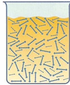
皂土片狀結構不鍵結，呈液態。
