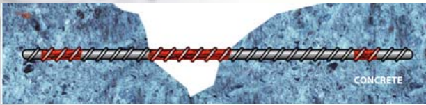
I. 修補剝落混凝土
